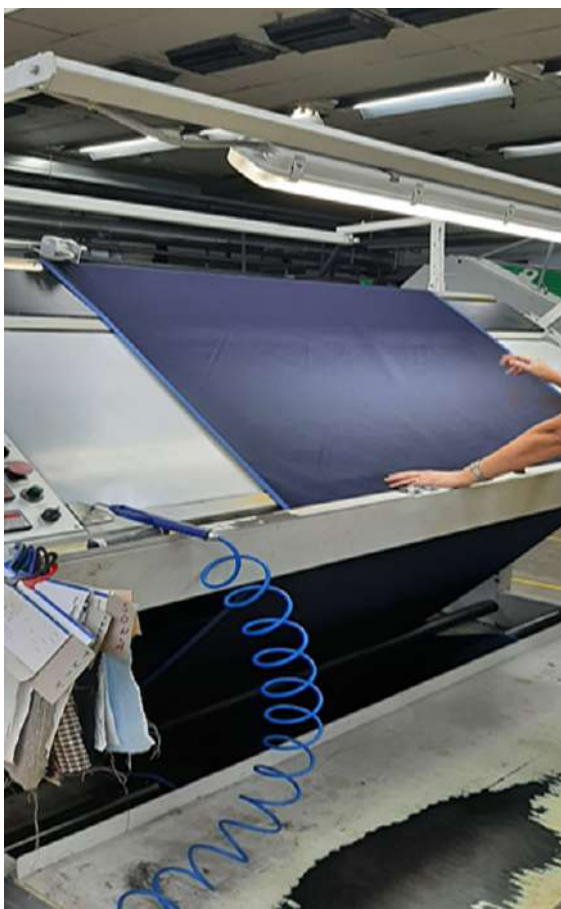
Фигура 1, Контролно-прегледна маса на суров плът в тъкачен цех
