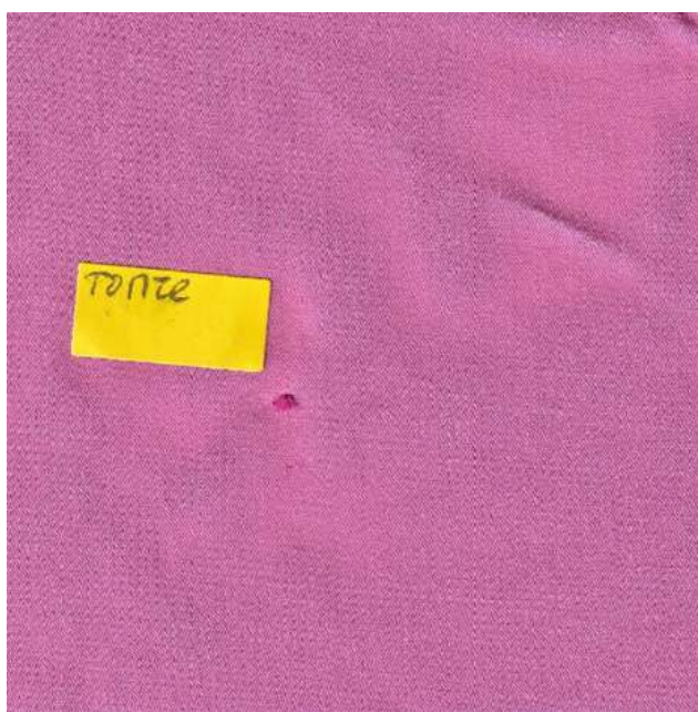
Фигура 2. Затъкани нишки под формата на тонче
