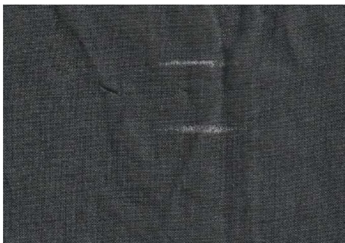
Фигура 4. Скъсан вътък със затъкан край
