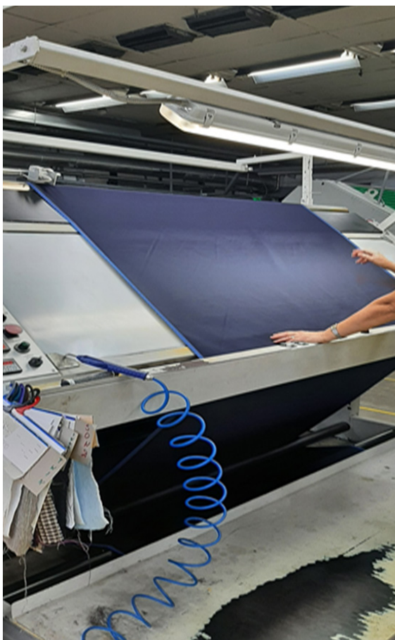
Фигура 1, Контролно-прегледна маса на суров плат в тъкачен цех
