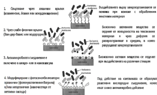
Фиг. 81. Механизъм на антимикробна активност на текстилните материали в зависимост от начина на свързване на антимикробните съединения с функционалните групи на текстилния материал
