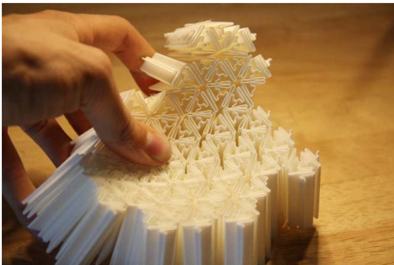
Фигура 21 3D принтиран материал с клетъчна мезоструктура. Дизайн на Андреас Бастиан. Източник: https://andreasbastian.com/Mesostructured-Cellular-Materials
