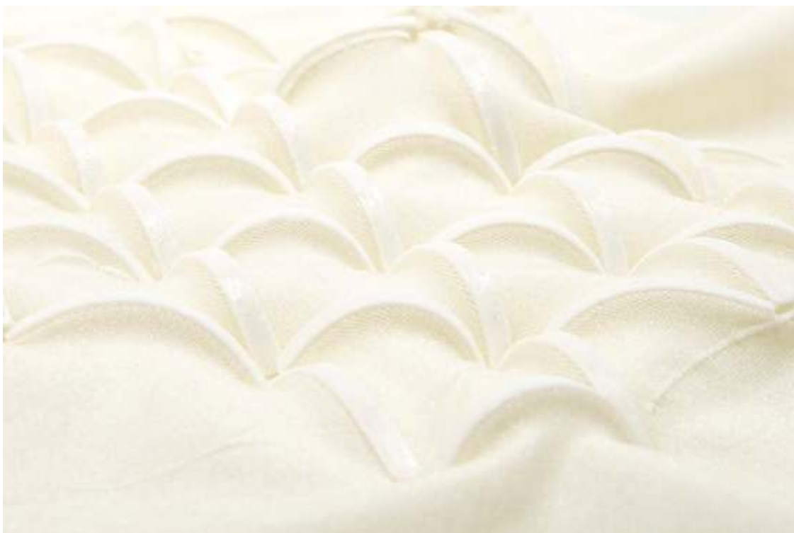
Фигура 23 Триизмерна текстилна структура, получена чрез 3D принтиране на плоскостен линейарен десен от синтетичен материал върху предварително обтегнат трикотажен текстил.
