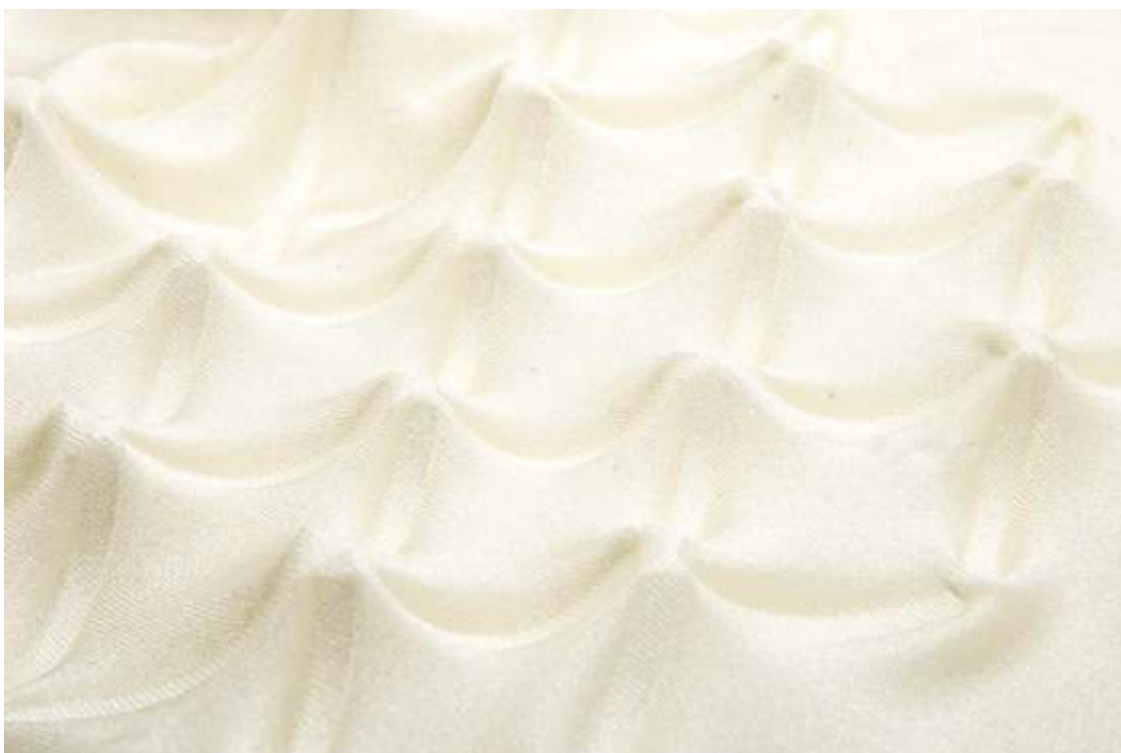
Фигура 24 Триизмерна текстилна структура, получена чрез 3D принтиране на плоскостен линейарен десен от синтетичен материал върху предварително обтегнат трикотажен текстил.
