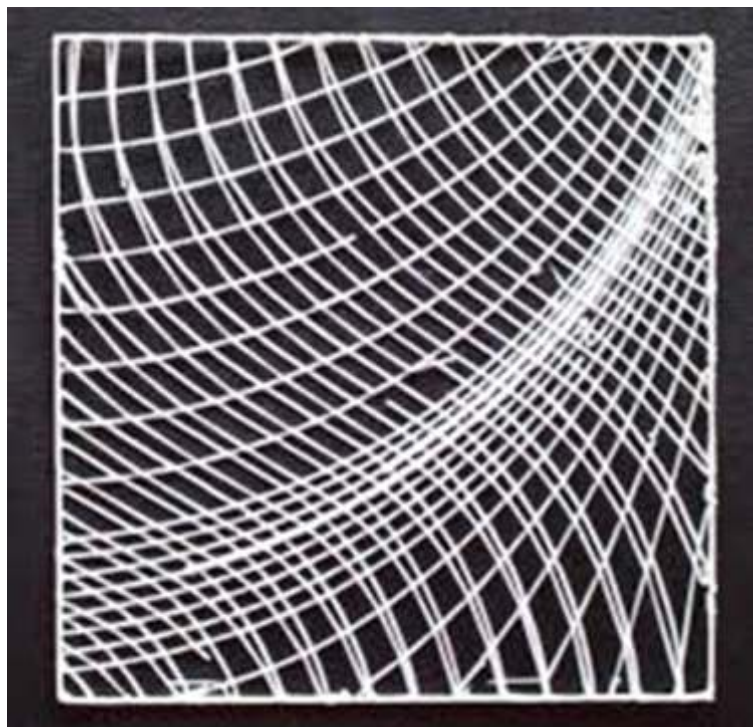
Фигура 4 3D принтирана структура от три слоя „нишки“, насложени един върху друг. [3] Разработка на R Melnikova, A Ehrmann, K Finsterbusc. 2014 г. Източник: https://iopscience.iop.org/article/10.1088/1757-899X/62/1/012018/pdf
