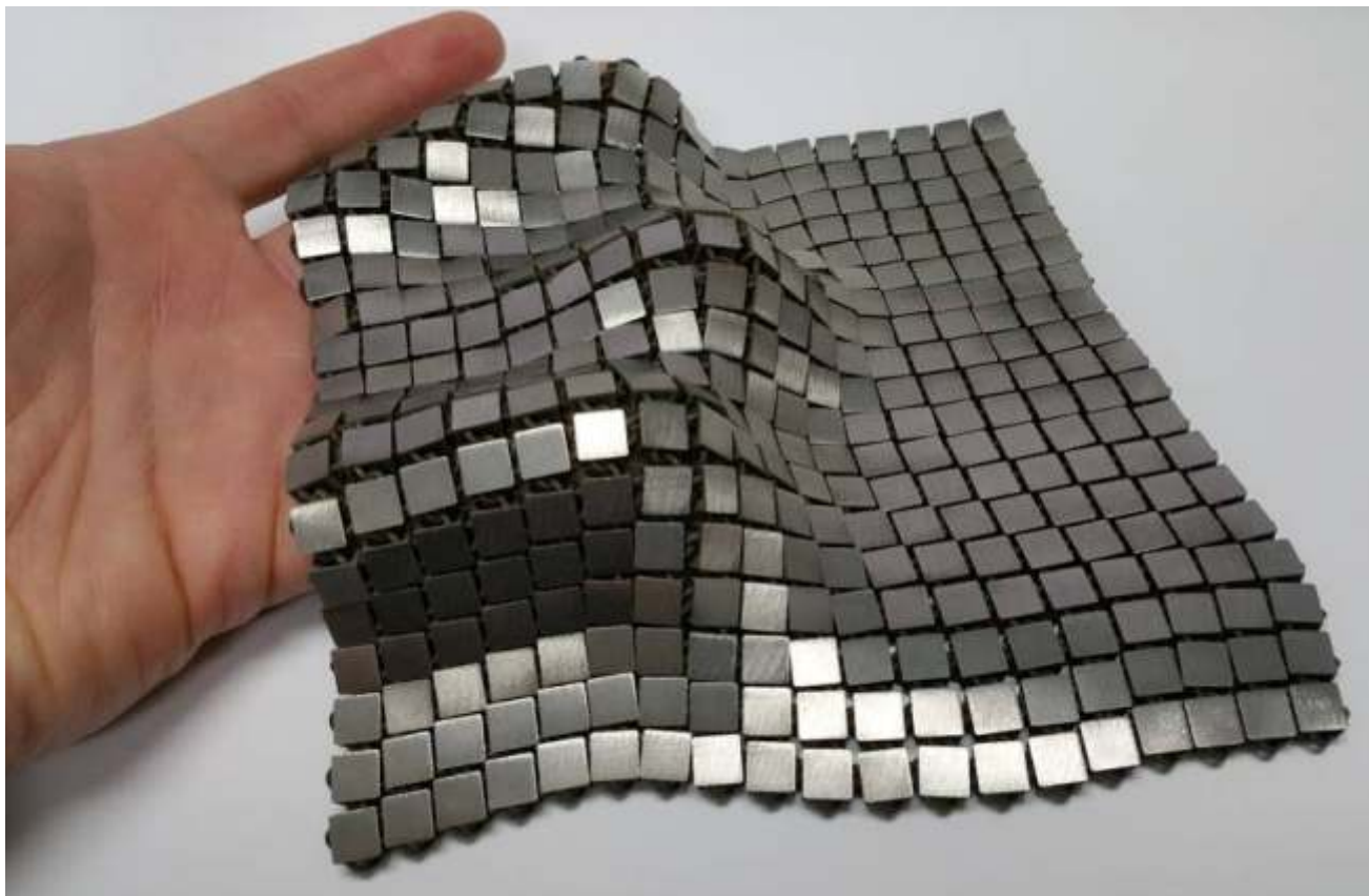
Фигура 15 3D принтиран „космически плат“, разработен от NASA на базата на структури, заимствани от металните ризници.
