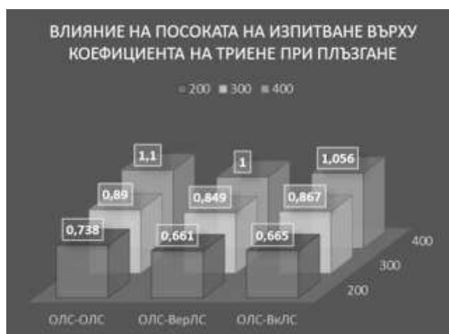
Графика 2 Влияние на посоката на изпитване върху коефициента на триене при плъзгане за Артикул 2 - Боро
