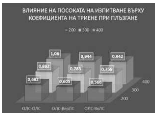
Графика 3 Влияние на посоката на изпитване върху коефициента на триене при плъзгане за Артикул 3 - Боби
