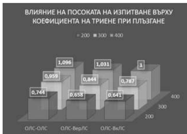
Графика 1 Влияние на посоката на изпитване върху коефициента на триене при плъзгане за Артикул 1 - Кипарис
