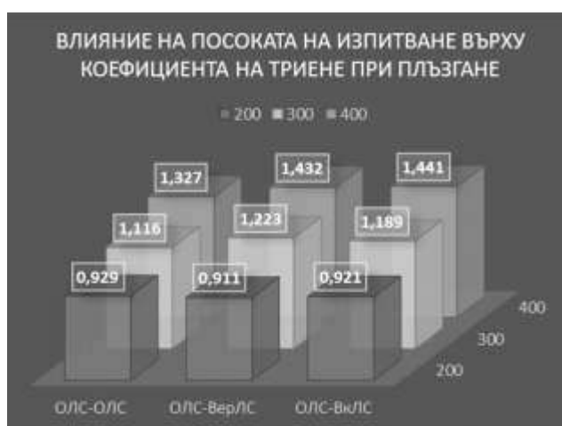
Графика 4 Влияние на посоката на изпитване върху коефициента на триене при плъзгане за Артикул 4 - Пирин
