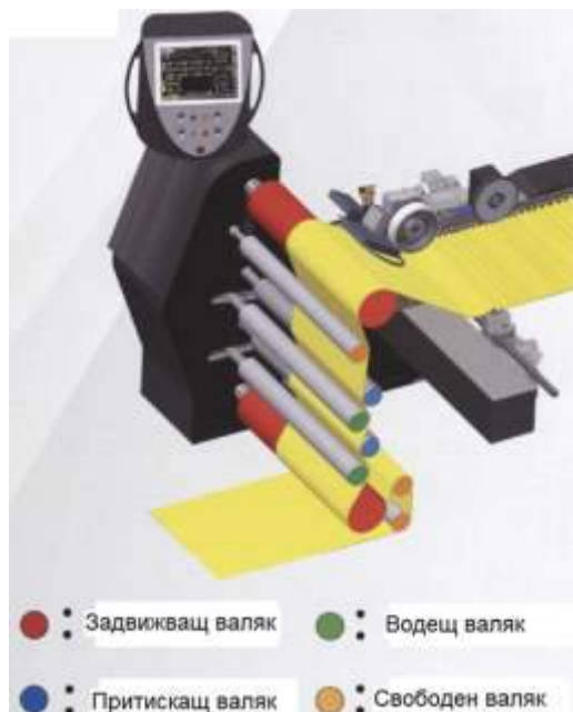
Фигура 4 Апарат за надипляне на плата на входа на шпан-рамата
