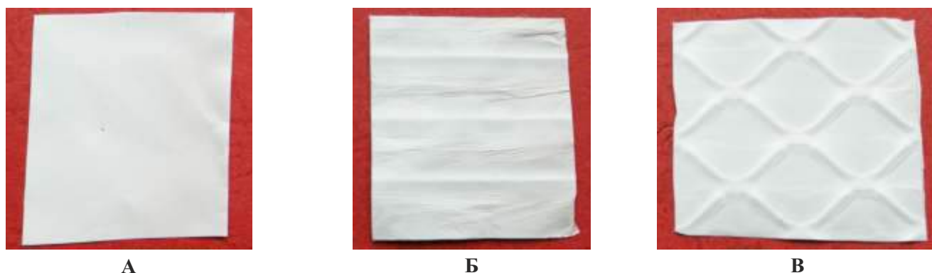
Фиг. 1 Снимка на влакнестите структури, получени върху различни видове въртящи се колектори: гладък цилиндричен (А), ножовиден (Б) и мрежа (В)
