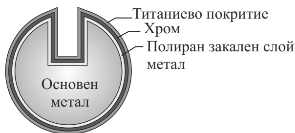
Фиг. 3 Схема-разрез на игла с покритие
