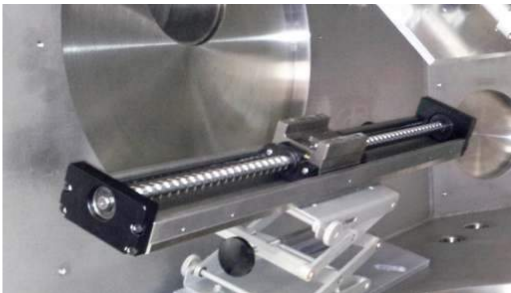
Фигура 3 Червячно задвижване на субстрато държача
