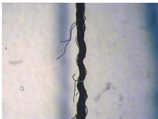
Фигура 7 Микроскопска снимка на основна нишка след изнищване
