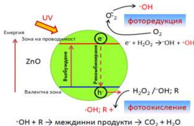
Фигура 1 Механизъм на фотокаталитична активност на \text{ZnO}
