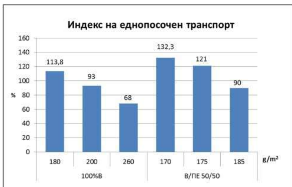
Фигура 8 Влияние на площната маса на лицевия плат върху индекса на еднопосочен транспорт при двуслойните системи
