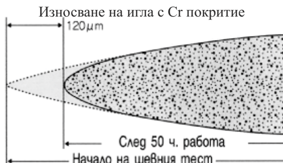
Фиг. 5 Тест за износване на иглата
