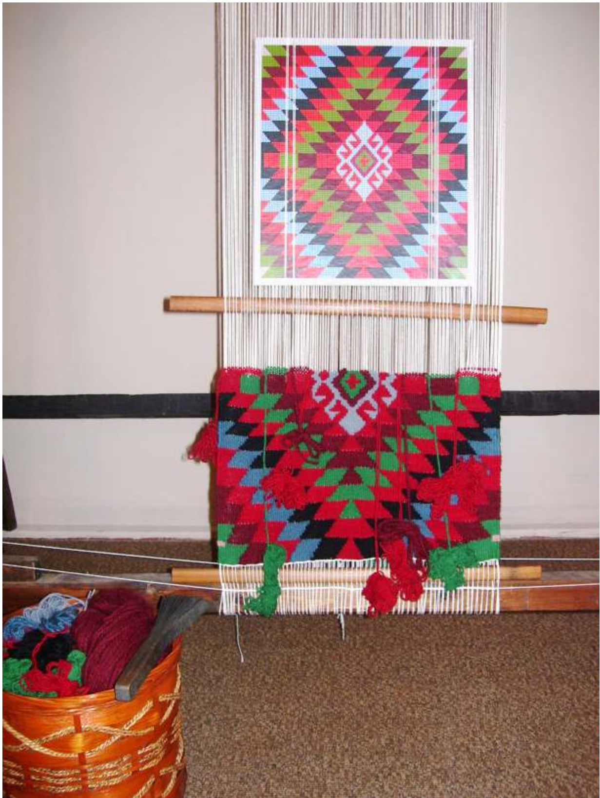
"Вертикален тъкачен стан за котленски килими" Колекция на Музей на текстилната индустрия в Сливен
